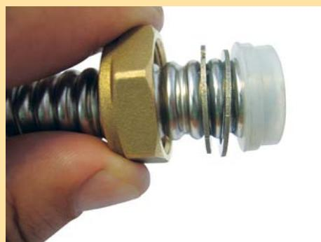
5. Вставляем трубу в корпус фитинга и затягиваем накидную гайку.
